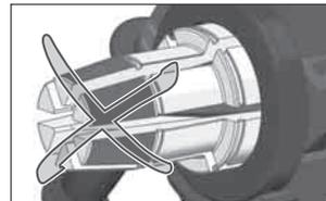
Ruotare i sei segmenti di allargatura in senso orario. La testa deve girare liberamente. La testa non deve girare in senso antiorario.
