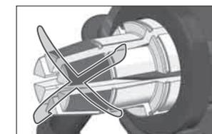
Draai de zes expandersegmenten met de klok mee. De kop kan vrij worden gedraaid. De kop mag niet tegen de klok in kunnen worden gedraaid. De expansiemanchet sluit in één lijn af met het gereedschap.
