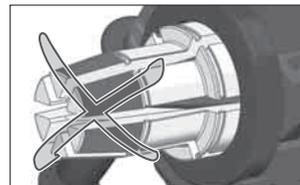
Die sechs Expandersegmente im Uhrzeigersinn drehen. Der Kopf lässt sich frei drehen. Der Kopf darf sich nicht gegen den Uhrzeigersinn drehen lassen.
