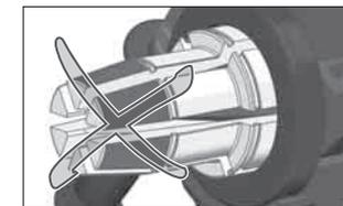
Поворачивать шесть сегментов расширителя по часовой стрелке. Головка должна вращаться свободно. Головка не должна вращаться против часовой стрелки.
