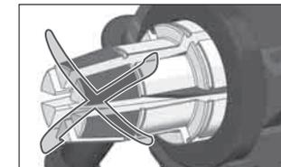
Girar los seis segmentos del extensor en el sentido de las agujas del reloj. El cabezal girará libremente. El cabezal no debe girar en sentido contrario a las agujas del reloj.
