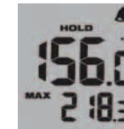
3. Puścić przycisk wyzwalacza. Zanim po około 7 sekundach nastąpi wyłączenie wskaźnika, wyświetlony będzie HOLD.
