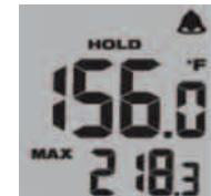
3. Laat de trigger los. Totdat het display na ongeveer 7 seconden uitschakelt, wordt HOLD weergegeven.
