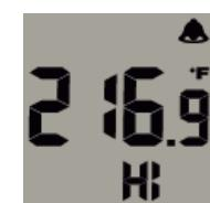
Appuyer sur les touches positionnées au dessus des flèches pour configurer les valeurs de température souhaitées. Attendre 5 secondes jusqu'à la mémorisation de la configuration, ensuite sortir du menu.
