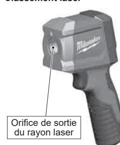
Orifice de sortie du rayon laser
