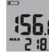
Gdy pojawi się symbol oznaczający niski stan akumulatora, należy dokonać jego wymiany.
