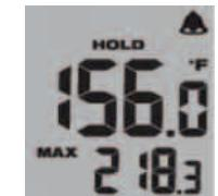
3. Отпустить спусковой крючок. До момента выключения индикации примерно через 7 секунд отобразится "УДЕРЖАНИЕ" (HOLD).
