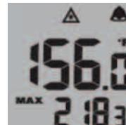
2. V kolikor sprožilec držite še naprej v pritisnjem stanju, se prikaže simbol  $\Delta$  in prikazani bosta temperatura površine (primarne meritve) in maksimalna temperatura (sekundarne meritve).
