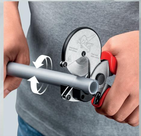
Besonders leichter Schnitt: Durch das drehbare Schneidrad lässt sich das Rohr reibungsarm in der Rohrschere drehen oder umgekehrt die Rohrschere ums Rohr.
