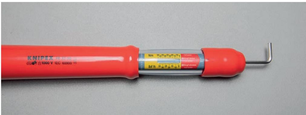
Abb. 4: Justierung des Drehmomentschlüssels
