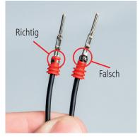
ACHTUNG! Bitte achten Sie immer auf eine korrekte Positionierung von Kontakt und Dichtung in der Zange.
