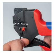
Schieben Sie nun das abisolierte Kabel inklusive Dichtung in die Zange und crimpen Sie den Kontakt.
