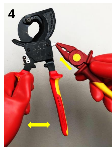
Bei gedrückter Halteklinke (2) die Griffe öffnen / öffnen lassen
