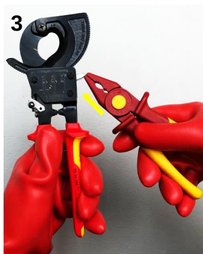
Bei geschlossen gehaltenen Griffen die Halteklinke (2) mit der isolierten, isolierenden oder Hybridzange nach oben drücken
