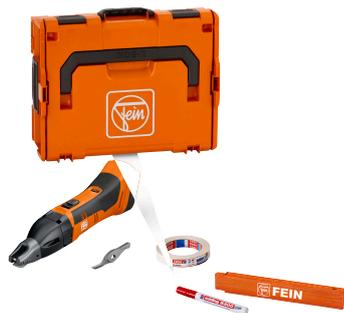
Handliche, kurvengängige Akku-Schlitzschere für verzugsfreie Abschnitte und Ausschnitte in Blechen bis 1,6 mm. Inklusive zusätzlichem Kurvenmesser, Permanentmarker, Malerband und Meterstab.
